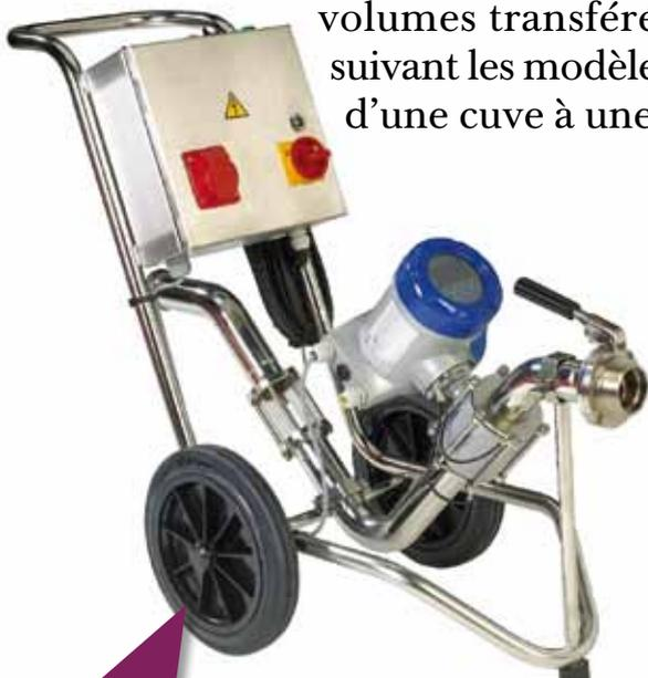
● **Le matériel :** L'œnocompteur se branche en aval d'une pompe pour en mesurer le débit. Pour produire cet appareil, les établissements Carles utilisent un débitmètre de la société Krohne, leader mondial de la mesure de débit. La précision est bien supérieure à celle des débitmètres mécaniques : elle est de 0,3 % pour le modèle 250 et de 0,02 % pour les modèles 500 et 700. Le tube de mesure ne contient aucun élément mobile. Parfaitement lisse, il se nettoie en même temps que la pompe.
